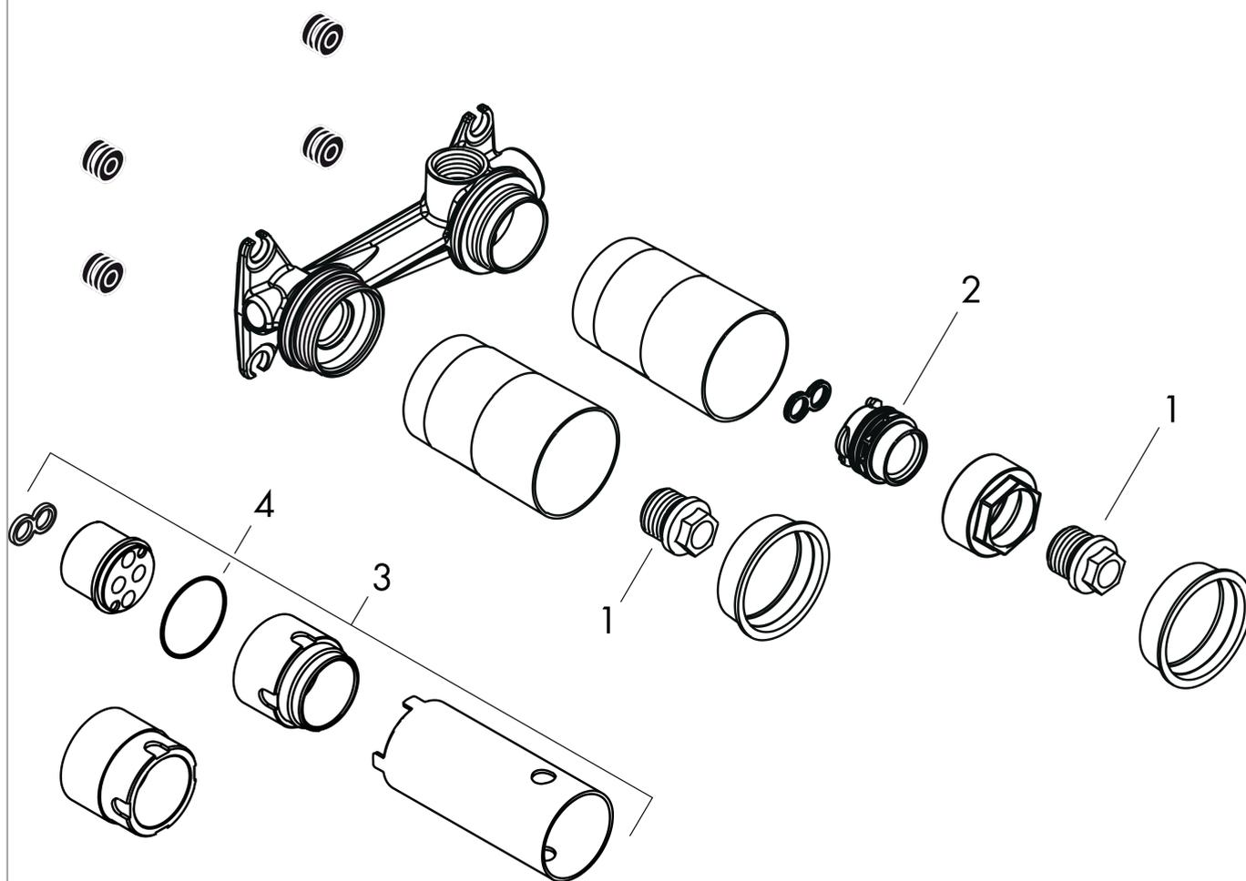
**Скрытая часть однорычажного настенного смесителя для раковины**Поверхности : п.а. Артикульный номер: **13622180**
