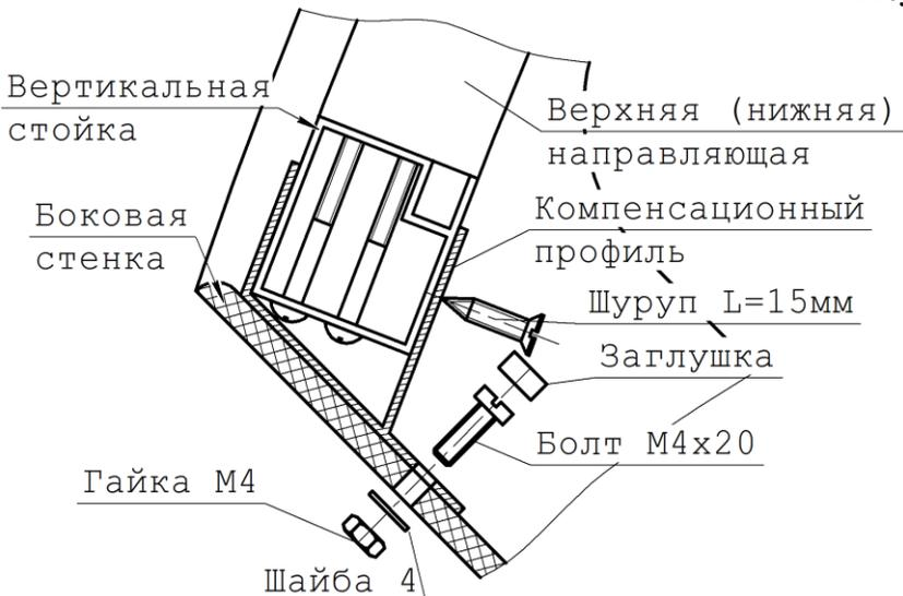
Предварительно нанести небольшое количество силиконового герметика на места стыков поддона, боковых стенок и рамы шторок для герметизации швов.
