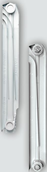
Боковое ребрение радиаторов «TENRAD AL» и «TENRAD BM» выполнено с наклоном в 4° – 6° к вертикали (патент RU 110461 U1), что позволяет получить конусные конвекционные воздушные каналы в радиаторной сборке.
