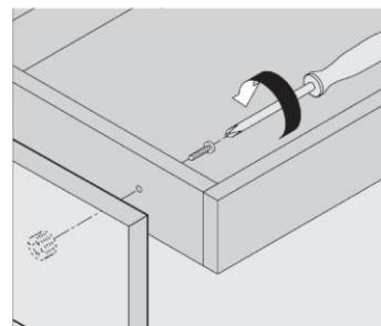
**Регулировка по высоте и ширине ±2мм
