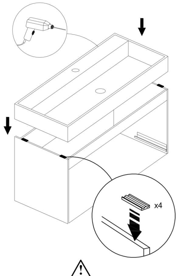
При использовании керамического умывальника наклейте уплотнитель из комплекта фурнитуры на торцы боковин тумбы во избежание их повреждения.
