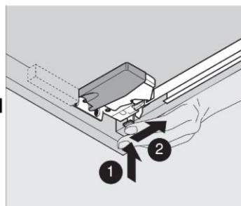
**Регулировка по высоте +3мм**
