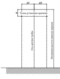
1 Определите необходимую высоту навески зеркала. Мы рекомендуем навешивать зеркало таким образом, чтобы верхний его край оказался на высоте 2000 мм от уровня пола. При таком расположении верхний край зеркала совпадает с верхним краем напольного пенала. Однако, вы можете выбрать удобную для вас высоту. Используя данные для вашей модели зеркала из таблицы №2 приложения, разметьте положение крепежа. Обязательно проверьте горизонтальность размеченных точек с помощью уровня.
