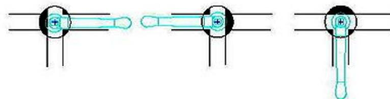
Тип затвора (L, T) обозначен на рукоятке и на торце штока.
