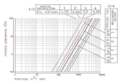
\*Графики приведены при подаче теплоносителя под золотник. При обратной подаче теплоносителя к Kv применяется коэффициент 0,88.
