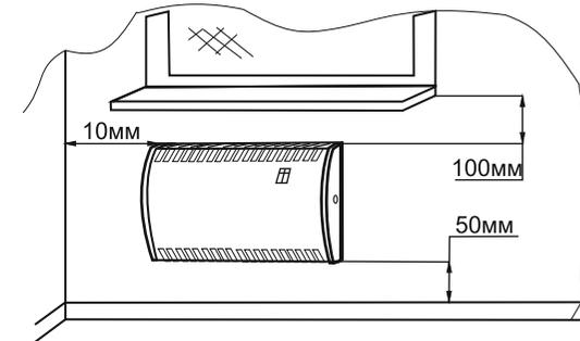
Рис. 3 Схема крепления кронштейнов для настенного монтажа электроконвектора
