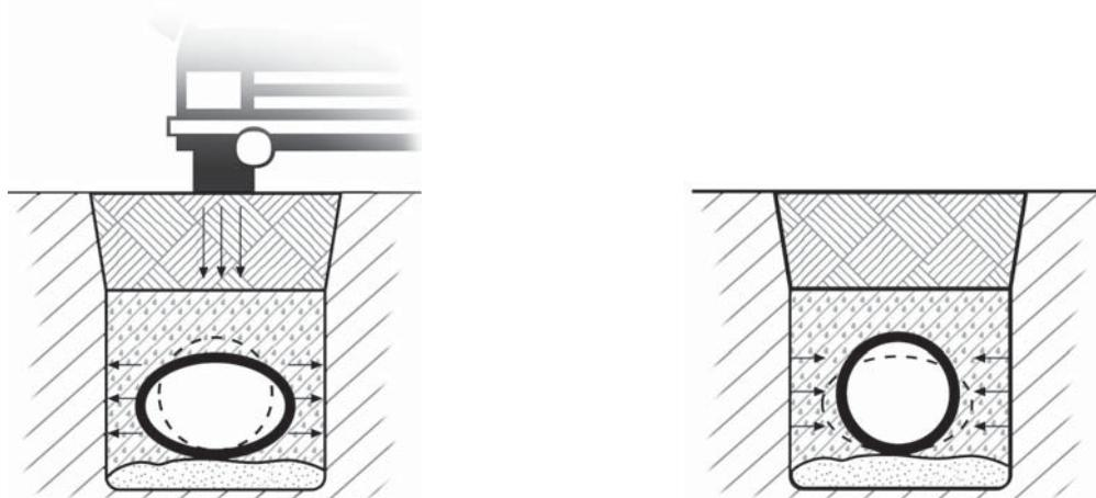
Рис. 2.5а. Воздействие на ПП трубу, ее деформация с передачей усилия на материал обсыпки
