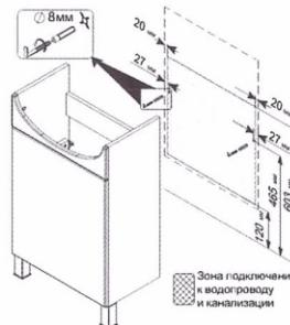
2. При монтаже подвесной тумбы под умывальник вначале закрепите тумбу, затем установите умывальник и наметьте места его крепления к стене. (Рис. 1 и Рис. 2).
