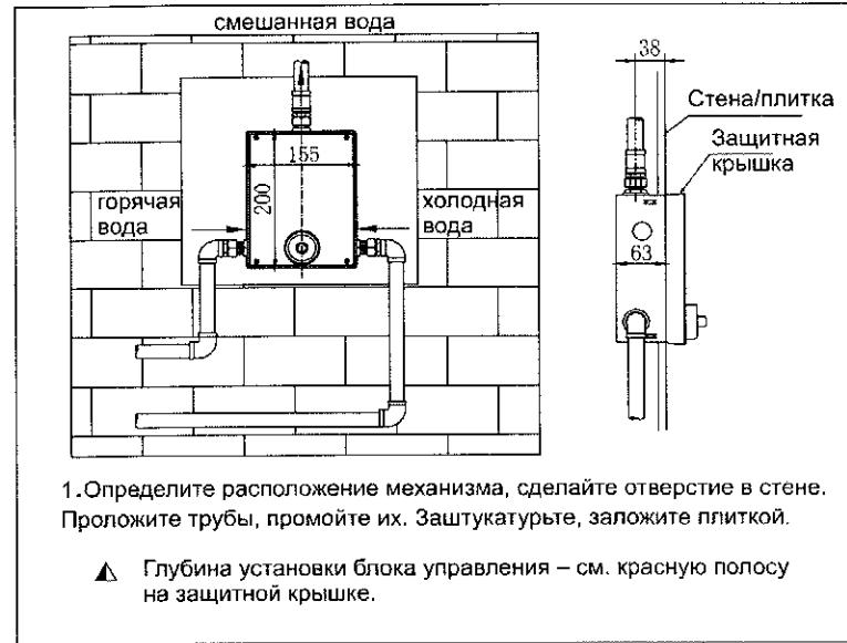
1. Определите расположение механизма, сделайте отверстие в стене. Проложите трубы, промойте их. Заштукатурьте, заложите плиткой.
