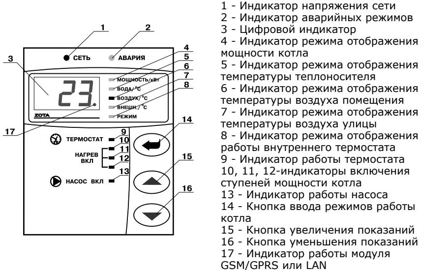
**Рис.2 Расположение органов управления на передней панели**
