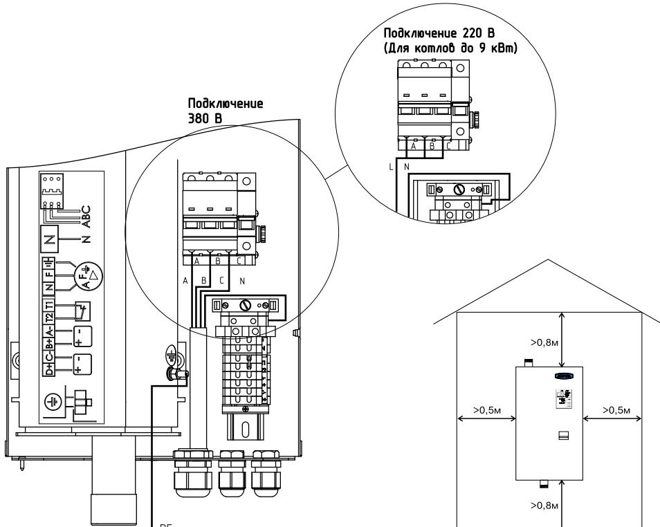
**Рис.3 Схема подключения котла**
