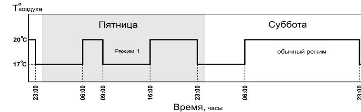
**Рис.8 График температуры воздуха в помещении для Режима 3**
