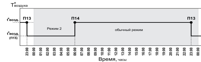
**Рис.7 График температуры воздуха в помещении для Режима 2**
