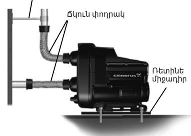
Նկար 7 SCALA2-ի աղմուկի նվազեցման համար միջոցառումներ
