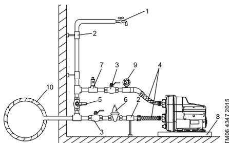
Рис. 8 Повышение давления воды из магистрального трубопровода
