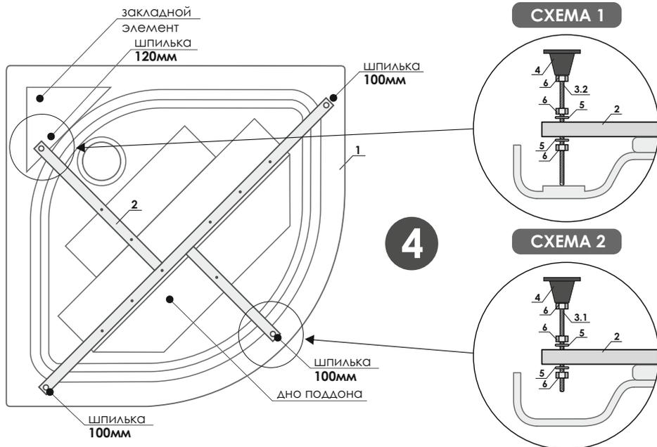
5. Прикрутите сварную раму ко дну поддона, используя шурупы 3,5х40
