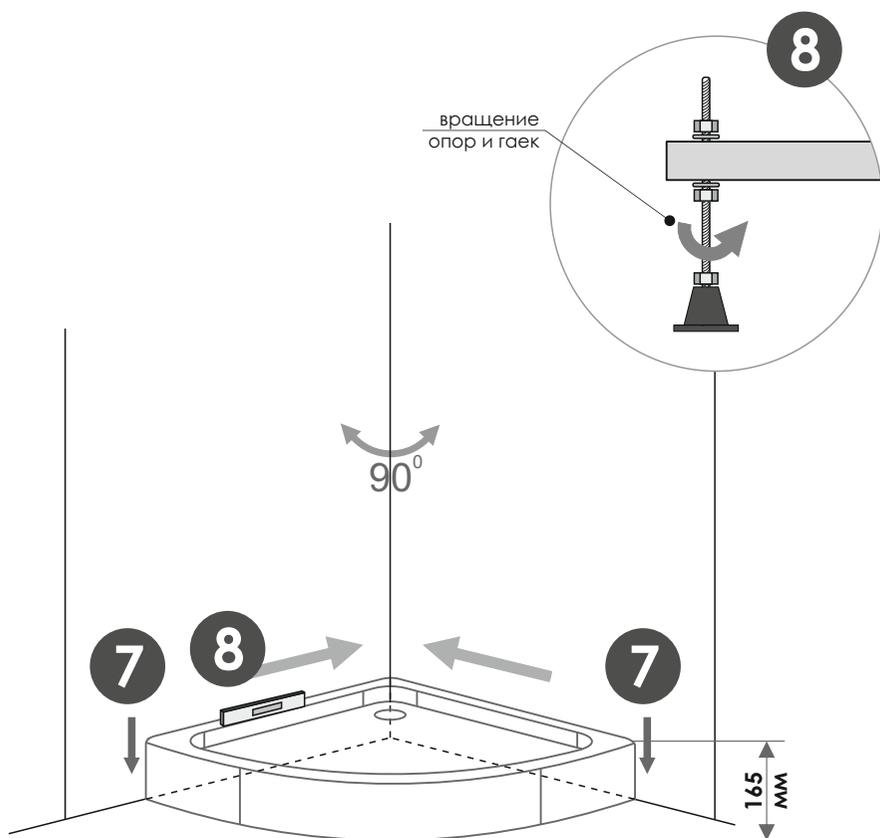
9. На стенах произведите разметку мест установки крепежных кронштейнов для фиксации поддона к стене, согласно схеме.
