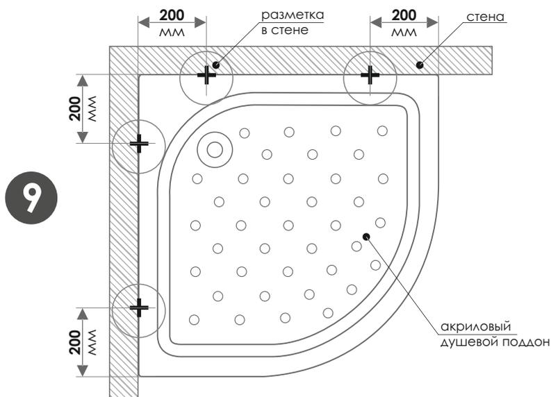
10. Уберите поддон в сторону и по нанесенной разметке установите крепежные кронштейны на стенах:
