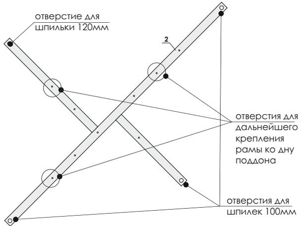
4. Разместите раму на дне поддона таким образом, чтобы свободный конец шпильки **120мм** упиралась в закладной элемент на дне поддона (схема №1).
