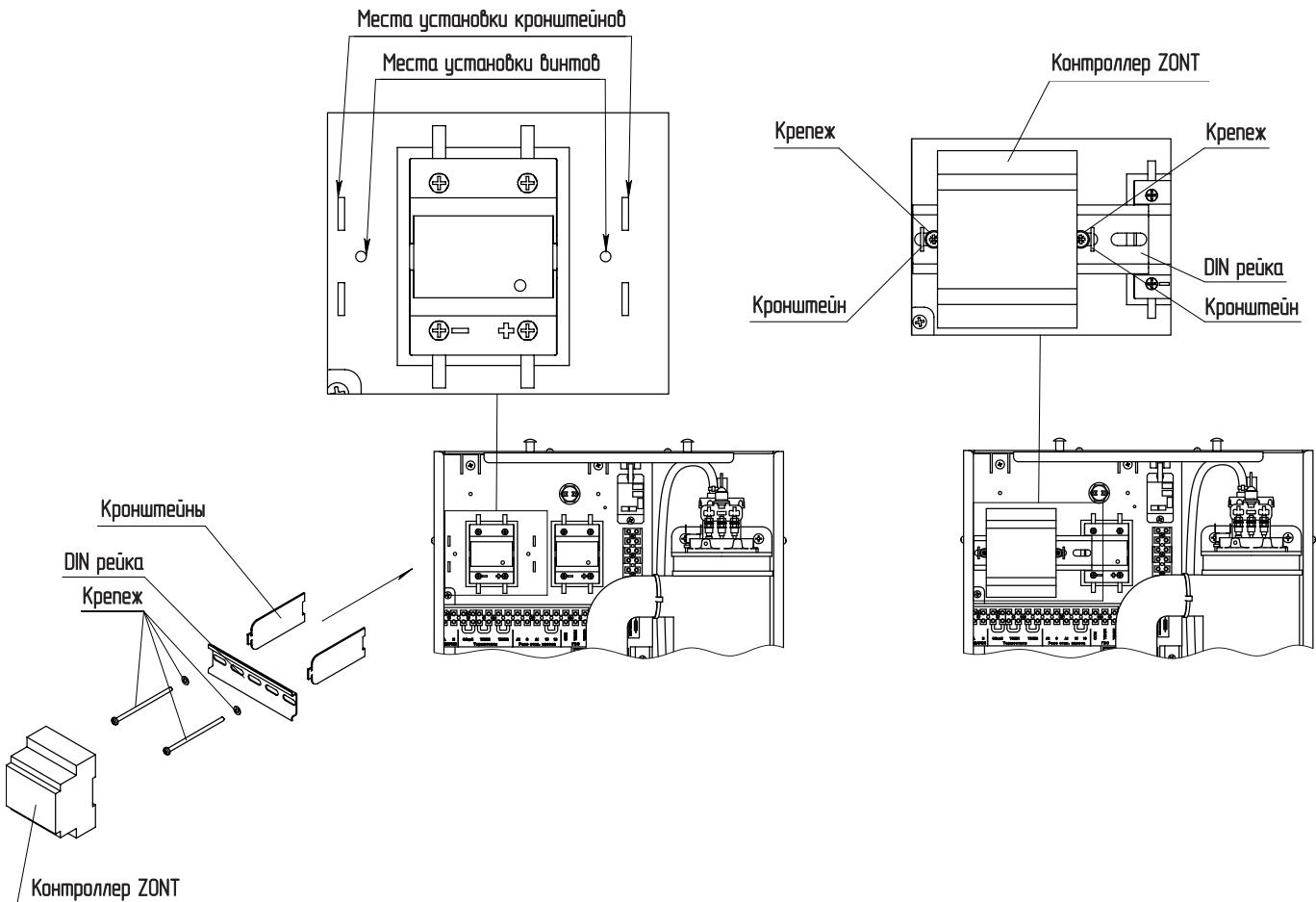
**Рис.6.1 Порядок установки контроллера ZONT для электрокотлов СИЛА «ВОЕВОДА» мощностью 12-15 кВт**
