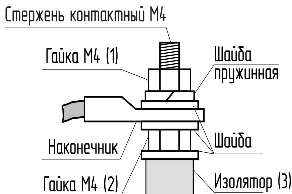
**Рис.8 Присоединение проводов к выводам блок ТЭН**
