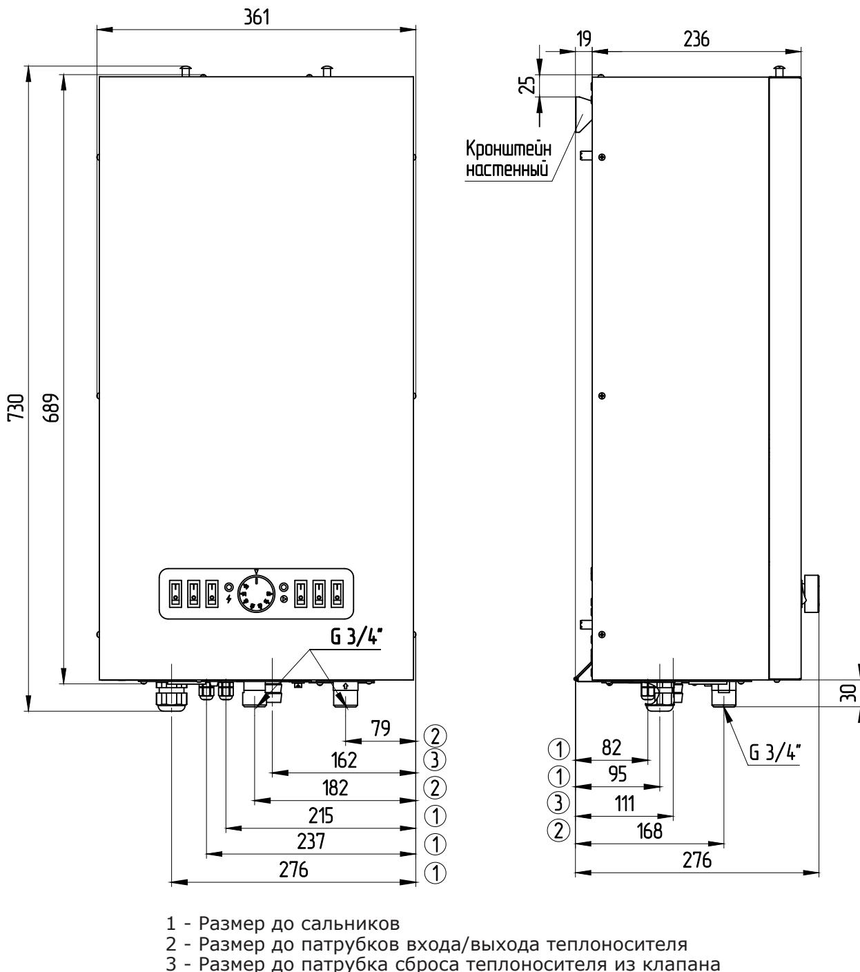
**Рис.3 Габаритные и присоединительные размеры**
