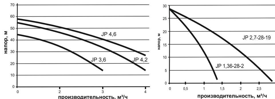
Рис.16 Напорно-расходные характеристики поверхностного вихревого насоса
