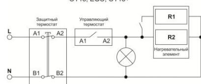
Рис. 10. Схема электрическая для моделей Steatite (S4CM).
