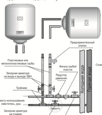
Рис. 5. Подключение ЭВН в вертикальном / горизонтальном положении
