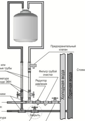
Рис. 6. Подключение ЭВН, который устанавливается под мойкой
