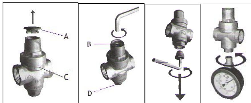
Настройка производится вращением настроечной гайки **B** шестигранным ключом **S5**. Вращение по направлению часовой стрелки увеличивает значение настроечного давления. Вращение против часовой стрелки уменьшает давление.
