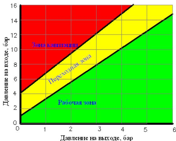
8.3. **Граничное условие 2:** соотношение давления на входе и на выходе должно быть таким, чтобы попадать в рабочую или переходную зону графика кавитации.
