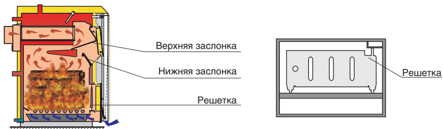
Рис.15. Процедура открытия дверей котла
