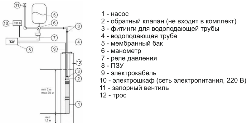
Рис. 3 Схема автономного водоснабжения с использованием погружного насоса
