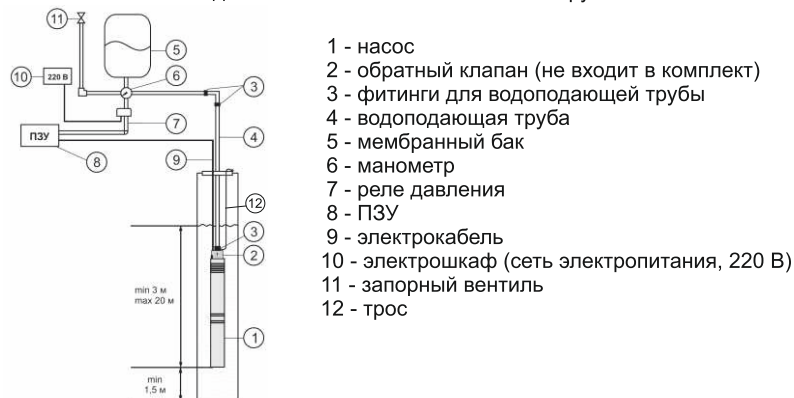
Рис. 3 Схема автономного водоснабжения с использованием погружного насоса
