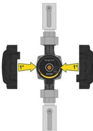
Рисунок 6: Изоляция корпуса насоса
