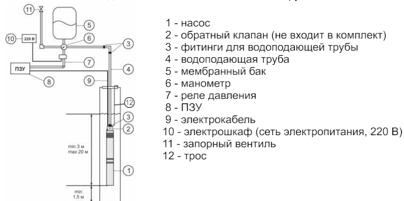
Рис. 3 Схема автономного водоснабжения с использованием погружного насоса
