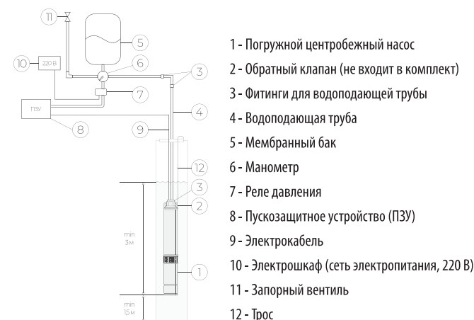
Рисунок 7. Схема автономного водоснабжения с использованием погружного насоса с выносным пускозащитным устройством (ПЗУ)
